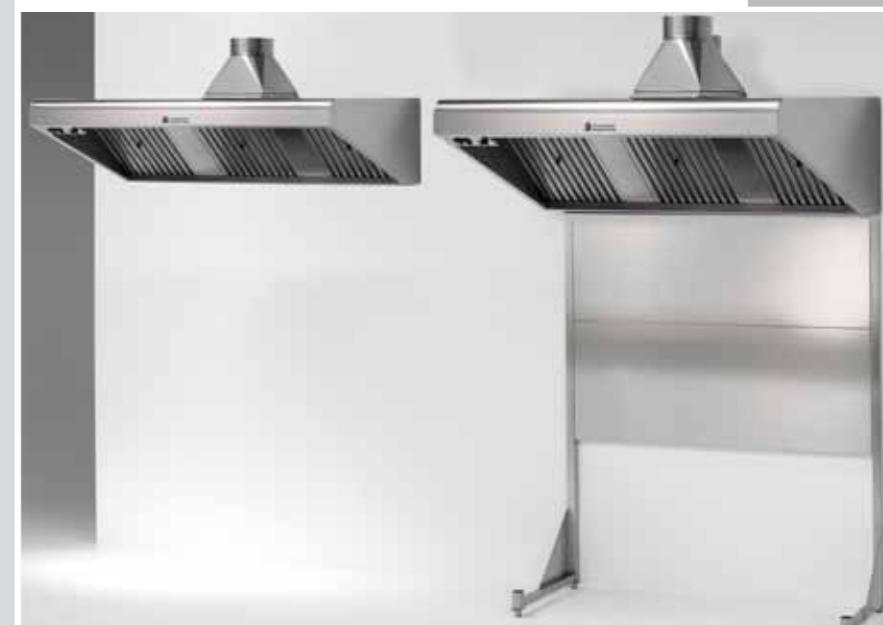
Fornite con o senza estrattore d'aria interno, complete di filtri inox a labirinto, plafoniera di illuminazione e variatore di velocità. Prodotte con profondità mm.850 per blocchi cottura da mm.600 o mm.700 e profondità mm.1050 per blocchi cottura da mm.900. Le versioni senza estrattore possono essere abbinate ad un aspiratore cassonato esterno di portata idonea. Tubazioni rigide in acciaio inox AISI 304 o flessibili in PVC completano l'offerta della componentistica necessaria.
