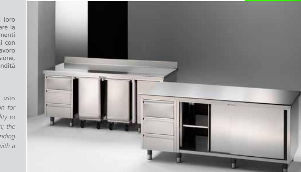
Il progetto è modulare e permette di assemblare tra loro elementi con diverse funzioni e dimensioni per realizzare la soluzione ottimale per ogni esigenza di lavoro. Gli elementi standard permettono la possibilità di realizzare banchi con dimensioni finite da mm.500 a mm. 2600; i piani da lavoro sono sp.10/10 o 15/10 h.mm.40 in funzione della dimensione, possono essere centrali o con sponda retro e con profondità da mm.600 mm.700 mm.800.
